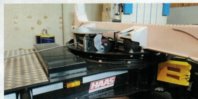
Die hydraulische Seilwinde für das Schlauchpaket hat eine hohe Zugkraft von 3,5 t. Sie ist serienmäßig mit Rollenfenster und Seilanpressrolle ausgestattet. Haas hat den Luftkessel am Drehschemel höher
